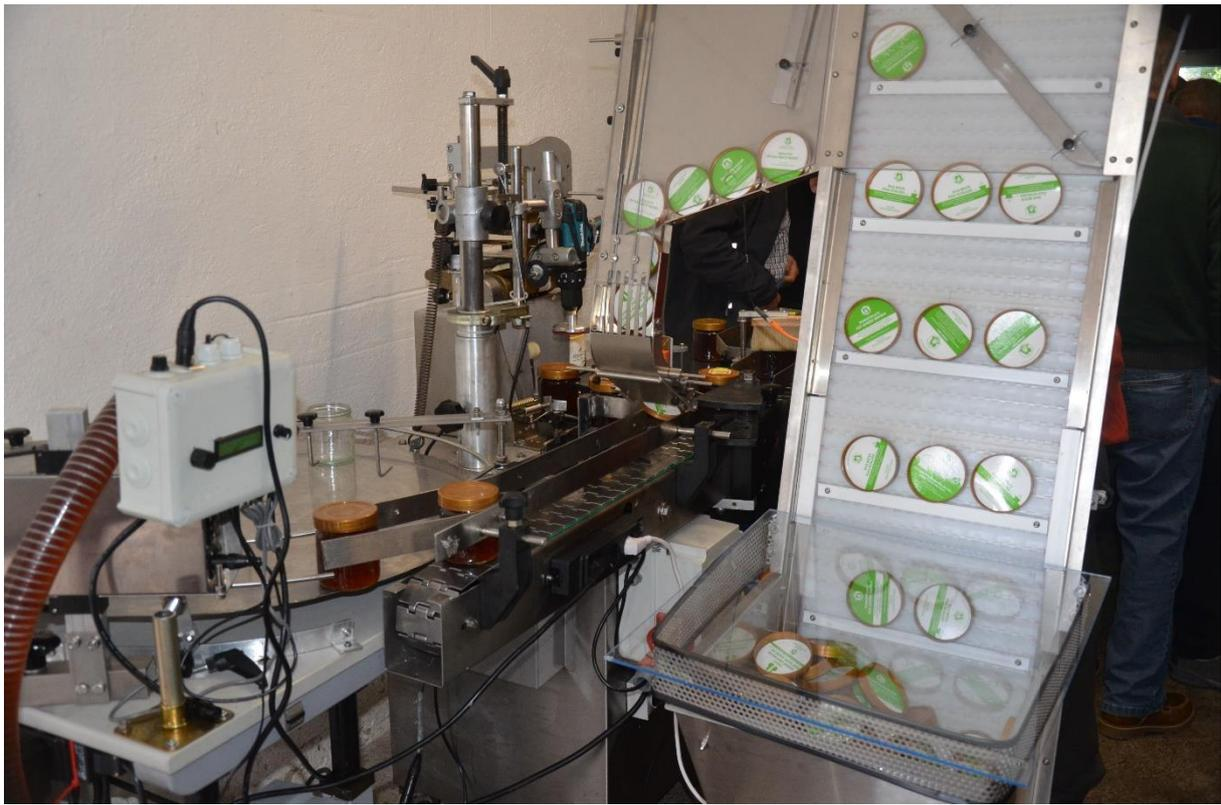
Bild: Der technisch versierte Imker Meinrad Leiter hat seine Honigabfüllung mit selber angepassten Maschinen rationell eingerichtet, im Bild die Abfüllung mit der Deckelsortiermaschine.
